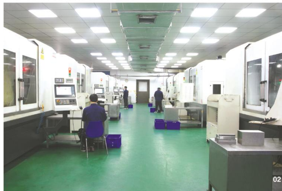
▼进口 CNC 电脑数控，机械牙板热处理后自动磨牙专用设备
