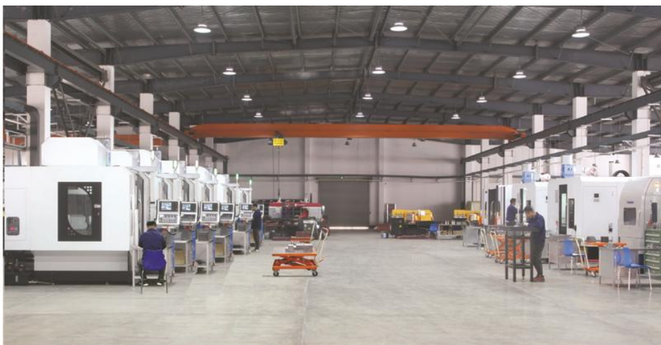
▲进口 CNC 电脑，牙板自动化设备产品生产
